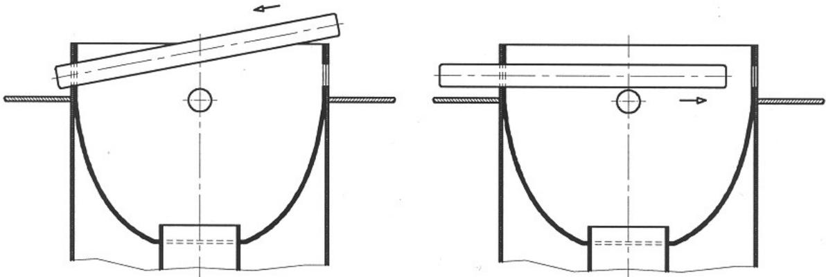
a.) Stab in Bohrung einführen, durchschieben
